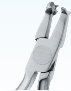
Pinza Hammerhead®, para NiTi | 678-327 Doblador multiuso, especial para aleaciones de níquel-titanio. No es necesario aplicar calor. Tamaño del alambre: < = .025" (0,63 mm)
